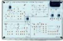
KL-25002 Egyenirányító, differenciáló és integráló modul
